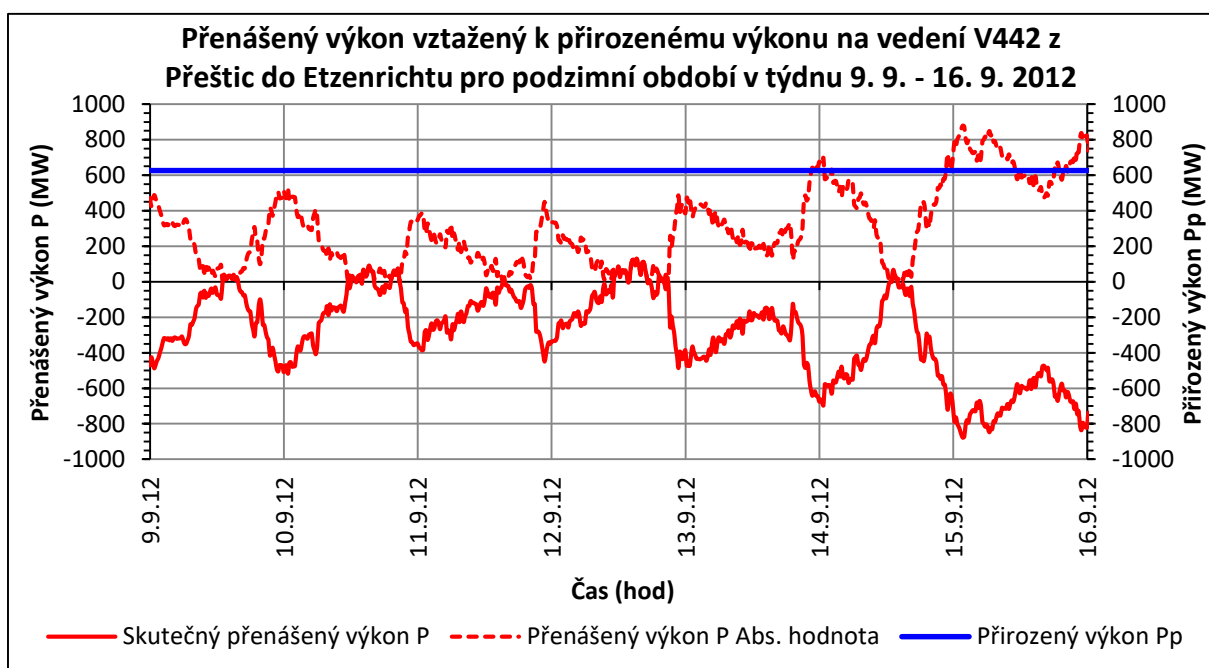
Graf 4.42 – Průběh přenášeného výkonu vztažen k přirozenému výkonu na hraničním vedení V442 z ČR do Německa pro podzimní období 9. 9. – 16. 9. 2012
