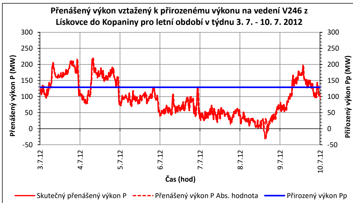
Graf 4.50 – Průběh přenášeného výkonu vztažen k přirozenému výkonu na hraničním vedení V246 z ČR do Polska pro letní období 3. 7. – 10. 7. 2012
