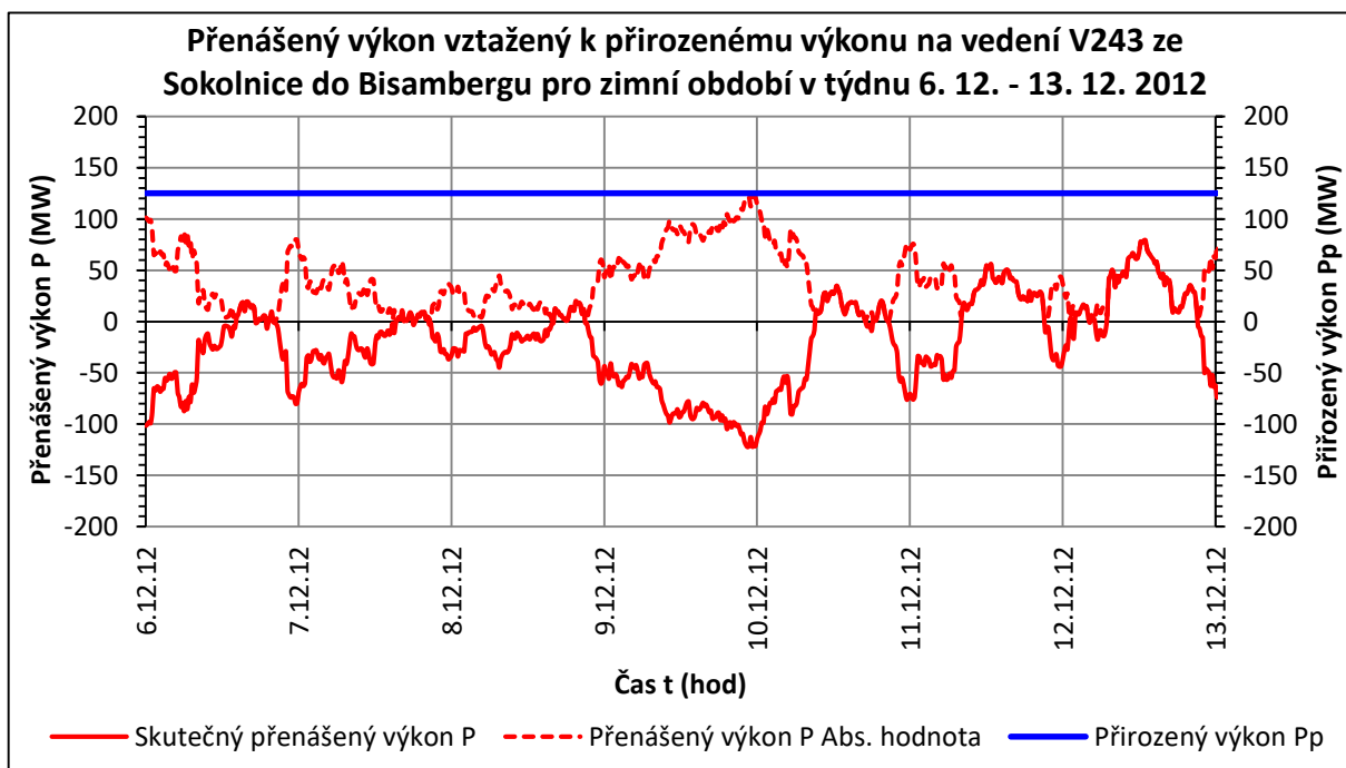
Graf 4.46 – Průběh přenášeného výkonu vztažen k přirozenému výkonu na hraničním vedení V442 z ČR do Rakouska pro zimní období 6. 12. – 13. 12. 2012
