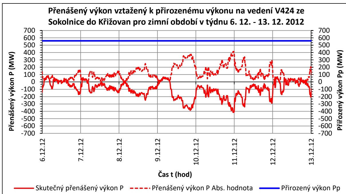
Graf 4.49 – Průběh přenášeného výkonu vztahen k přirozenému výkonu na hraničním vedení V442 z ČR na Slovensko pro zimní období 6. 12. – 13. 12. 2012
