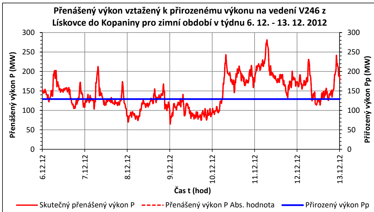
Graf 4.52 – Průběh přenášeného výkonu vztažen k přirozenému výkonu na hraničním vedení V246 z ČR do Polska pro zimní období 6. 12. – 13. 12. 2012
